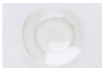
1. 1941 2. USA 3. Umættet poly-ester, UP 4. Dicarbonsyrer, poly- eller dioler 5. Flydende, opløst i styren 6. Hærdeplast 7. Glasfiberarmeret: Møllevinger, tanke, telefonbokse, støbeplast, forseglinger, både, pop-peller
