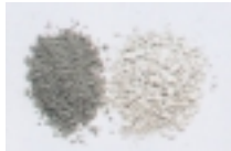
1. 1909/1923 2. USA, Tyskland/Øst-rig 3. Phenol- og aminoplast 4. Phenol, cresol, formaldehyd, delv. m fyldstoffer 5. Pulver, granulat 6. Hærdeplast 7. Elektroisoleringsdele, askebægre, elektriske kabinetter
