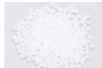
1. 1958 2. USA 3. Acetatplast, POM 4. Formaldehyd 5. Granulat 6. Ter-moplast 7. Tandhjul, kontor- og husholdningsmaskiner, telefon-, radio-, fono-, TV-apparater
