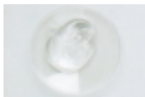
1. 1943 2. USA 3. Siliconeplast 4. Silicium, methylchlorid 5. Olier, pastaer 6. Termoplast 7. Afstøb-ningsforme, fugemasser, kabler, tætninger, imprægneringsmidler
