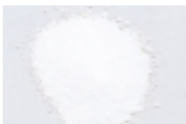
1. 1941 2. USA 3. Polytetrafluorethylen, PTFE 4. Tetrafluorethylen 5. Pulver 6. Termoplast 7. Temperaturbe-ständige belægninger, tætninger, isolering
