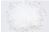
1. 1930 2. Tyskland 3. Polystyren, PS 4. Benzen, ethylen 5. Granulat 6. Termoplast 7. Emballage, lege-tøj, skumisolerig, husholdnings-artikler
