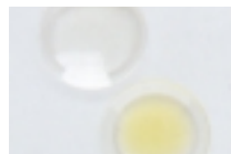
1. 1946 2. Schweiz 3. Epoxyplast, EP 4. Epichlorhydrin, diphenyl-propan 5. Harpiks og hærder 6. Hærdeplast 7. Fiberarmeret: Sportsrekvisitter, fly- og skibsdeler: støbeplast
