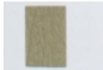
1. 1859 2. Storbritannien 3. Vulkan-fiber 4. Cellulosehydrat 5. Halvfabri-kata 6. Hærdeplaster 7. Kufferter, pakninger
