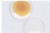
1. 1940 2. Tyskland 3. Polyurethan, PUR 4. Isocyanat, polyol 5. Væsker 6. Hærdeplast/termoplast/elastomer 7. Sportsartikler, isolering til køle-skabe og byggeri
