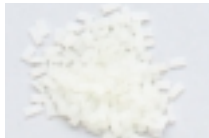
1. 1938 2. Tyskland 3. Polyamid, PA 4. Syreamider 5. Granulat 6. Termoplast 7. Typehjul til skrivemaskiner, tandhjul, skruber, bilbremseslanger
